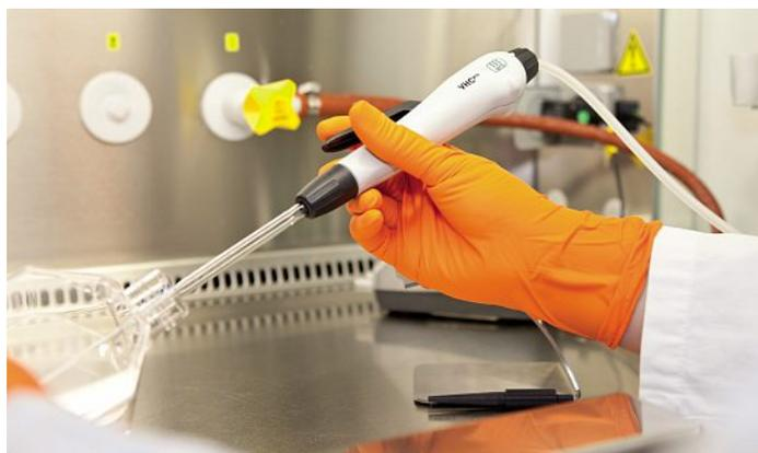
freie Absaugen grösserer Flüssigkeitsmengen kann mittels Drehknopf auf Dauersaugen umgestellt werden. Die Flüssigkeitsabsaugsysteme BVC mit dem neuen Handgriff VHC<sup>pro</sup> und dem umfangreichen Zubehörprogramm helfen, die Arbeit im Zellkulturlabor oder in der Sicherheitswerkbank deutlich sicherer und komfortabler zu gestalten.
