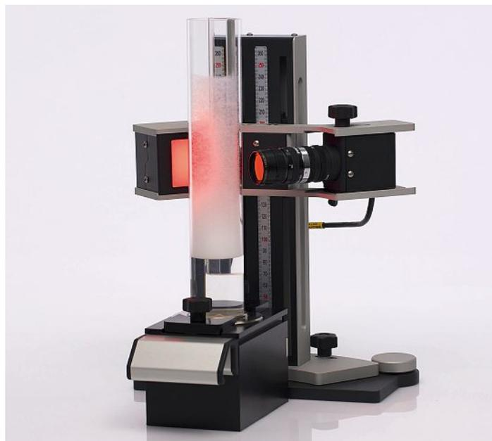
Modul zur Schaumstrukturerkennung / Module for foam structure analysis
