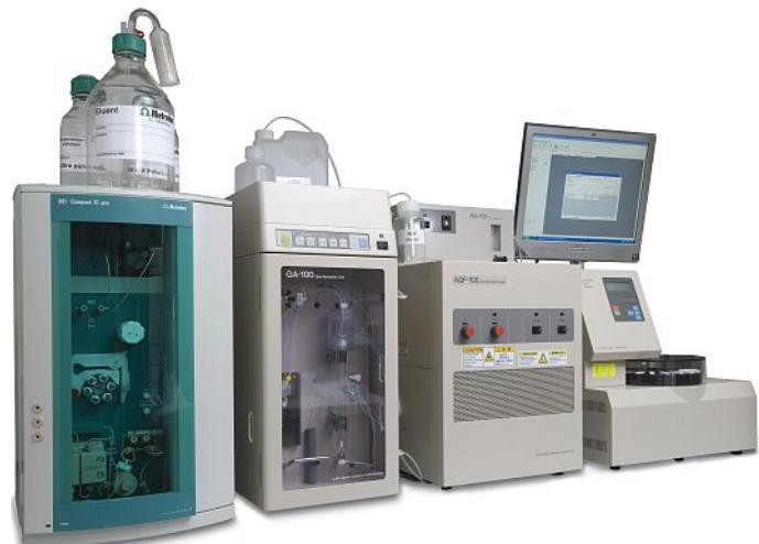
Combustion IC von Metrohm kombiniert thermischen Probenaufschluss und ionenchromatographische Analyse in einem neuen, leistungsstarken System. Combustion IC ermöglicht die vollautomatische und simultane Bestimmung von Halogenen sowie Schwefel in sämtlichen festen und flüssigen brennbaren Proben.
