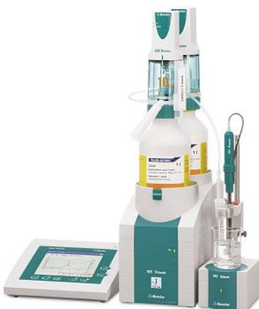
Gesamtsäure und pH-Wert sind zwei der am häufigsten bestimmten Parameter in der Getränkeindustrie. Der pH-Wert wird meist mittels pH-Meter gemessen, während zur Bestimmung der Gesamtsäure oft noch mittels Glasbürette und NaOH-Lösung von Hand titriert wird. Dabei können folgende Probleme auftreten:
