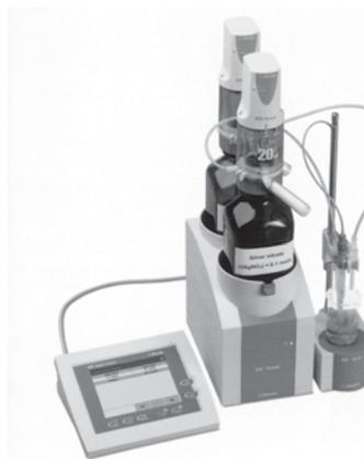
werden. Neben dem kontrollierten Dosieren werden die Parameter pH (oder Spannung) und Temperatur kontinuierlich aufgezeichnet. Damit wird der Synthesevorgang lückenlos dokumentiert. Auch das Dosieren kann mit zwei Dosinos im Tandembetrieb unterbrechungsfrei erfolgen. Als Novum übernimmt
