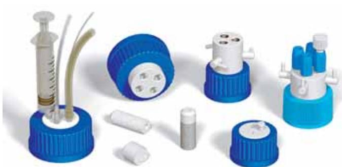
Deckel können über im Lieferumfang enthaltene PTFE-Kegel direkt hartwandige Schläuche mit einem Aussendurchmesser von 1/8" angeschlossen werden. Über Viton® O-Ringe oder PTFE-Kegel sind hartwandige Schläuche mit einem Aussendurchmesser von 0,5 bis 4 mm angeschlossen.
