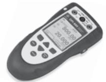
externen Druckmoduls UPM in eine Druckanzeige umgewandelt werden. Es stehen 22 Messbereiche von 25 mbar bis 700 bar mit einer Fehlergrenze von bis zu 0,01% vom Messbereich zur Verfügung. Das robuste ergonomische Gehäuse mit beleuchtetem Display sowie die einfache Bedienung über wenige Tasten machen diese Geräte zu idealen Testwerkzeugen in der Industrie.
