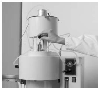
einem neuen System von Büchi Labortechnik ist nun erstmals auch ein System im Labormassstab verfügbar. Der etablierte Sprühtrockner «Mini Spray Dryer B-290» ist so erweitert worden, dass auch Sprüherstarrungen durchgeführt werden können. Das Zubehör besteht aus einem thermostatisierbaren Gefäss für den Feed, einer Heizung mit Regelung und einem
