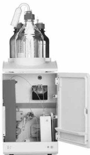
häuse integriert: Injektor, gradientenfähige Hochdruckpumpe, Säulenheizung, Nachsäulenreaktor, Reagenzpumpe und der komplett neu entwickelte Dioden Array UV/VIS-Detektor. Ein einfacher PC genügt, um das vollständige System zu steuern. Die IC-Net-Software steht für einfache und logische Bedienung des Systems.
