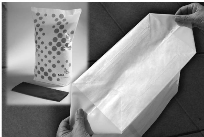
Ein Tyvek®-Deckblatt im Kreuzboden des Transportsacks von Bischof + Klein lässt überschüssige Luft entweichen, die beim Befüllen mit pulverförmigen Schüttgütern in den Sack eingetragen wird. Staubpartikel werden sicher zurückgehalten. Für das Vakuum-Entlüften bietet der Hersteller ganz aus Tyvek® bestehende Säcke an.
