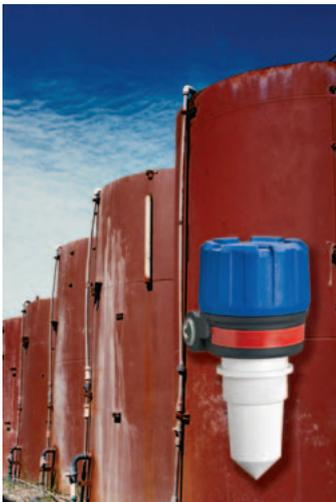
Das neue Modell R82, ein berührungsloser Radarmessumformer mit 26 GHz in 2-Leiter-Technologie von Magnetrol ist ein hochleistungsfähiger und dennoch kostengünstiger Füllstandmessumformer, der nach dem Impulsradarprinzip arbeitet. Kurze Mikrowellenimpulse von 26 GHz werden ausgesendet und von der Flüssigkeitsoberfläche reflektiert. Der Flüssigkeitsfüllstand wird dann entsprechend der Tankhöhe und den Sensor-Offset-Werten des Kunden berechnet.
