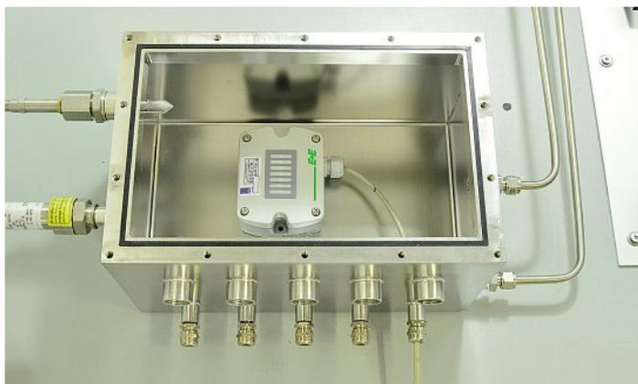
Zur Kalibrierung befinden sich die Messgeräte in einer Messkammer mit exakt definierter Gaskonzentration. Fotos: E+E Elektronik GmbH.
