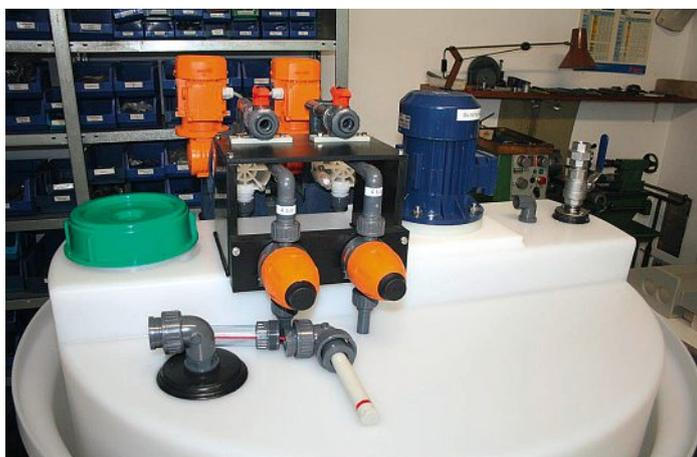
Abbildung 1: Mischbehälter 500 l mit Sicherheitswanne, zwei integrierte Dosiersysteme mit zwei GF-Überströmventilen als Sicherheitseinrichtung. (Quelle: UTEC Umwelttechnik GmbH)
