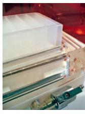
Der Acryl-Manifold von Porvair Sciences Ltd. wurde unter Berücksichtigung der Kompatibilität mit allen nach den geltenden ANSI/SBS-Normen gefertigten Platten für die Festphasenextraktion, Filtration, Proteinausfällung und für Sammelplatten entwickelt.
