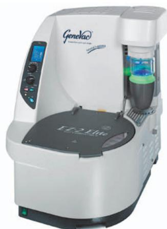
Genevac hat den EZ-2 Elite auf den Markt gebracht – eine Erweiterung seines erfolgreichen Sortiments an EZ-2 Evaporatoren. Der EZ-2 Elite entfernt Lösungsmittel mit hohem Siedepunkt und sorgt für eine verbesserte Lösungsmittel-Rückgewinnung. Dadurch wird die abschliessende Trocknung hartnäckiger Proben verbessert und die abschliessende Lyophilisation von HPLC-Fractionen ermöglicht.
