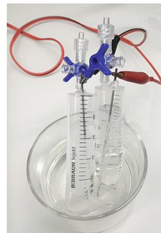
Abb. 1. Experimente mit Gasen: Analyse der Luft mittels Rosten und Spalten von Wasser in die Elemente
