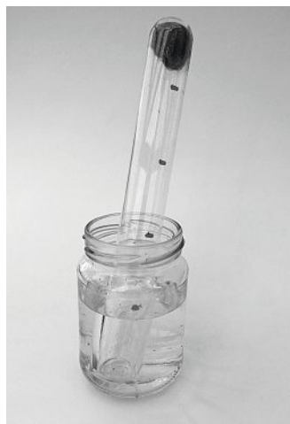
Abb. 1. Experimente mit Gasen: Analyse der Luft mittels Rosten und Spalten von Wasser in die Elemente
