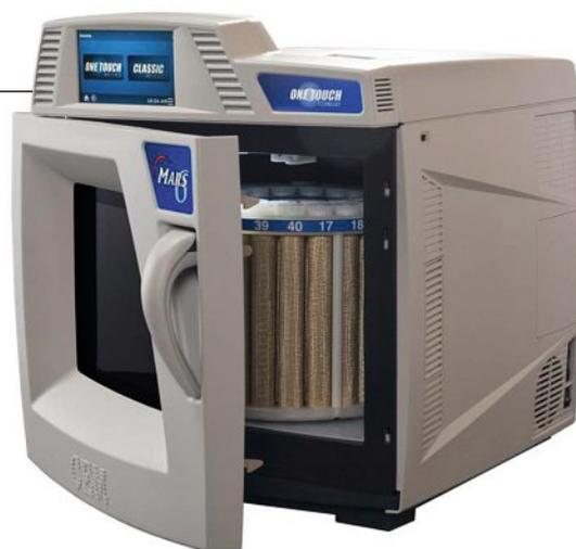
und den Behältertyp. Ausserdem werden die Temperaturen sämtlicher Behälter auf dem iPhone Touch-Screen des Mars 6 visuell dargestellt. Die neuartige Sensortechnik kontrolliert direkt die Reaktionskinetik der Aufschlussreaktionen und regelt daraufhin die optimale Mikrowelleneinwirkung. Ein eingebauter Drucker gibt alle Daten heraus und die USB-Schnittstellen ermöglichen eine Anbindung an PCs. Eine eingebaute Kamera überwacht zudem die Reaktionsverläufe der Aufschlüsse.
