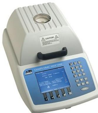
Mit dem neuen, wegweisenden Computrac® MAX®5000XL bringt Arizona Instruments einen auf Thermogravimetrie basierenden Moisture Analyzer auf den Markt der kaum Wünsche offen lässt. Neben der Restfeuchtebestimmung in Festkörpern und Flüssigkeiten kann auch der Anteil anorganischer Bestandteile durch Veraschung bestimmt werden.
