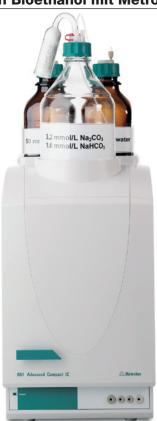
Bioethanol eignet sich als umweltschonendes Substitut hervorragend zur Beimischung in konventionelle Kraftstoffe. Mit Metrohm IC-Systemen lassen sich wichtige Qualitätsparameter wie der Sulfat- und Chloridgehalt automatisch und mit höchster Präzision bestimmen.
