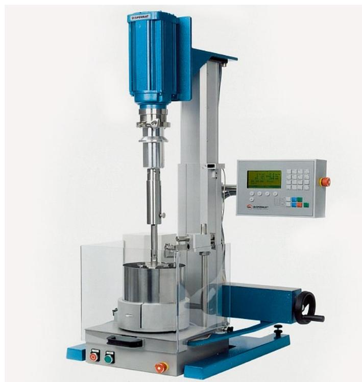
Zur Dispergierung hochviskoser und nicht-flieffähiger Substanzen ist nun das modulare, universell verwendbare Abstreifsystem ASC erhältlich. Das kompakte Gerät lässt sich einfach und schnell mit wenigen Handgriffen an jeden DISPERMAT® Labordissolver adaptieren.
