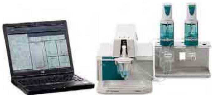
Der VA Computrace 797 von Metrohm bietet Cyclic Voltammetric Stripping Analysis (CVS) oder Cyclic Pulse Voltammetric Stripping Analysis (CPVS) für die Bestimmung aller Arten von organischen Additiven (Glanzbildner, Grundeinbeiner usw.) in galvanischen Bädern.
