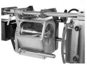
Für die direkte Kalanderbeschickung ist der Hochleistungskneter quantec® mit einer neu entwickelten Schneidvorrichtung ausgestattet, die Schmelzestücke von einheitlicher Grösse ergibt (im Bild ist die Schneidvorrichtung von der Düsenplatte abgehoben)
