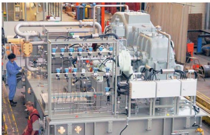
Eines der drei Schmierölmodule für die neuen Hitachi-Turbinen H25 kurz vor der Verladung. Mit 85 t Leergewicht sind die Module die schwersten, die Allweiler bisher konstruiert und montiert hat. Die Module für die Kraftwerke Matra und Nyiregyhaza sind 4,5 m breit, 6,5 m lang und knapp 4 m hoch. Werkbild: Allweiler AG, Radolfzell
