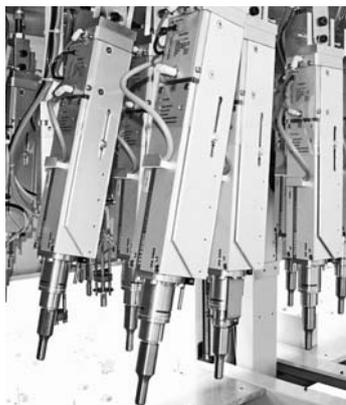
Als Weltneuheit stellt die Telsonic AG ein sehr kompaktes und preiswertes Ultraschall-Schweisgerät vor. Die Vorschubeinheit mit integriertem Generator ist sehr schlank gebaut und ermöglicht dem Kunststoff-Schweismaschinenbau neue Anwendungen. Die Technologie des zum Patent angemeldeten Neuprodukts IPA 3505 ist darüber hinaus günstiger als die herkömmliche Ultraschall-Schweis-Technologie und tritt nun in den Wettbewerb mit anderen Fügeverfahren.
